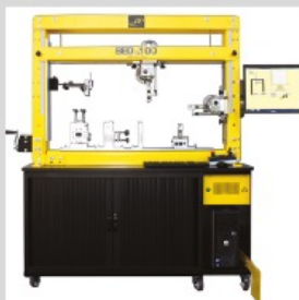
Figure 4 : Banc didactique de RDM 3R BED 100
